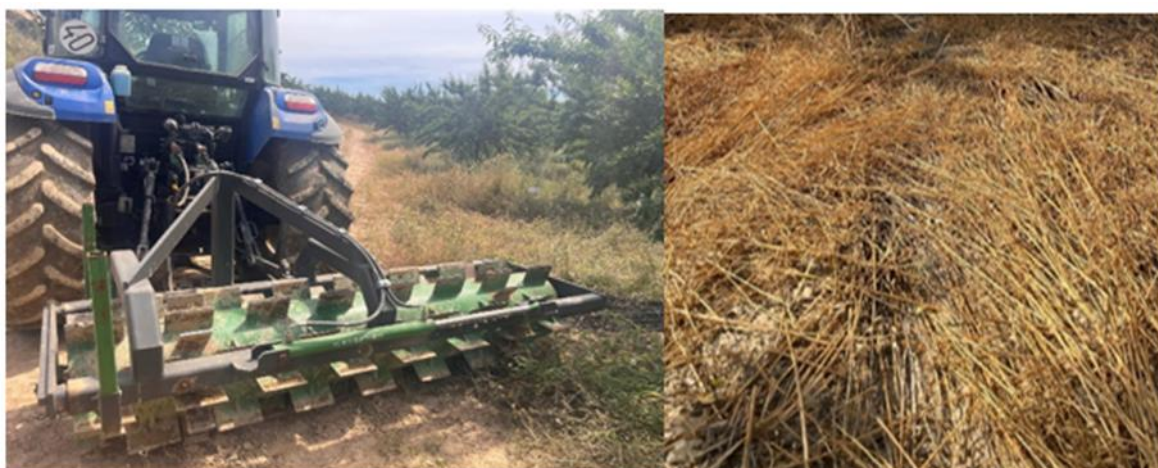
Figura 4. Detalle del “roller-crimper” (izquierda) y del estado de la cubierta de mostaza tras la finalización con este método (derecha).
